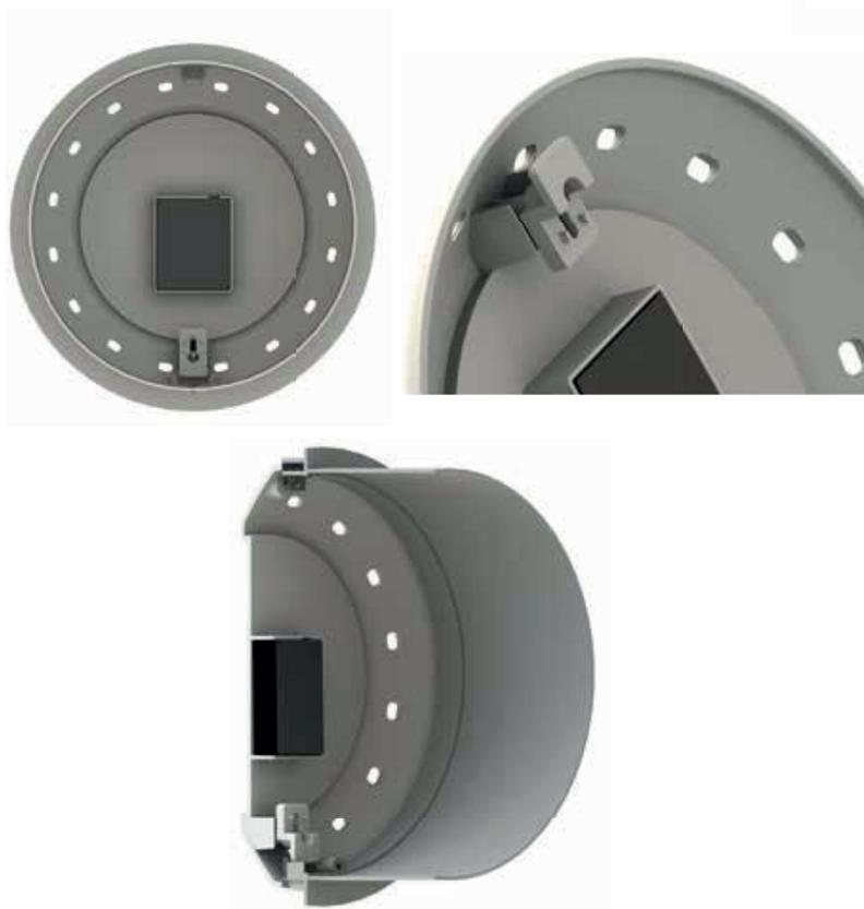
Figura 1 Indicação de como se monta a trava para nicho
